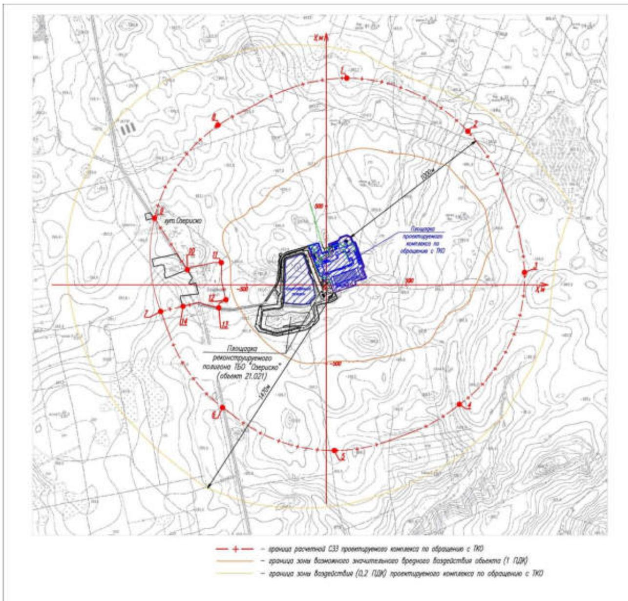
Рис.5.9 – Карта-схема с границами зон воздействия (Вариант 2)
